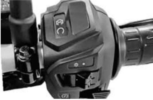
**Interruptor de luces :** Tiene 2 posiciones. Cuando el interruptor de encendido está en la posición "ON" y el motor está en la posición "ON", el sistema de iluminación funcionará según la tabla indicada
