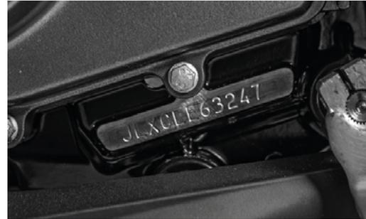
El número de Motor se ubica en la parte inferior del motor del lado Izquierdo, justo debajo de la palanca de cambios.
