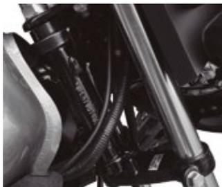
El número de VIN se ubica en la parte frontal derecha del chasis, justo en frente del tanque de combustible.
