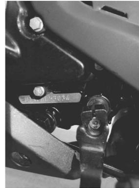
El número de Motor se ubica en la parte inferior del motor del lado izquierdo, justo debajo de la palanca de cambios.
