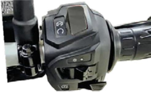
**Interruptor de luces :** Tiene 2 posiciones. Cuando el interruptor de encendido está en la posición "ON" y el motor está en la posición "ON", el sistema de iluminación funcionará según la tabla indicada
