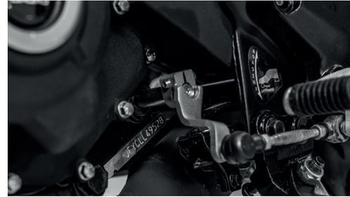
El número de Motor se ubica en la parte inferior del motor del lado izquierdo, justo debajo de la palanca de cambios.
