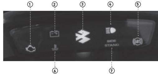
1. **Indicador de mal funcionamiento** : Se iluminará cuando se encuentren problemas en algún componente del sistema de inyección de combustible.
