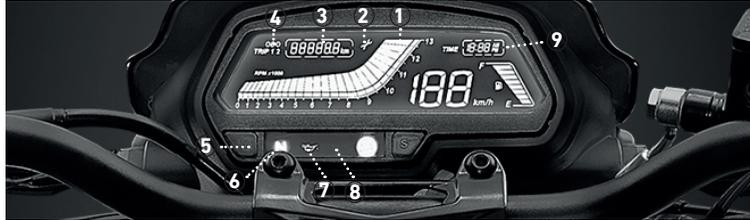
1. **Tacómetro:** Muestra la velocidad de giro del motor en RPM.
