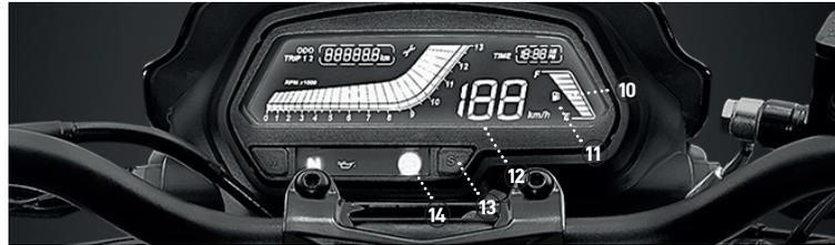
10. **Indicador de nivel de combustible** : Muestra un nivel aproximado de combustible dentro del tanque.
