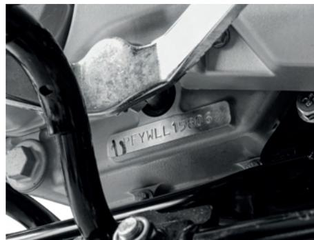
El número de Motor se ubica en la parte inferior del motor del lado izquierdo, justo debajo de la palanca de cambios.
