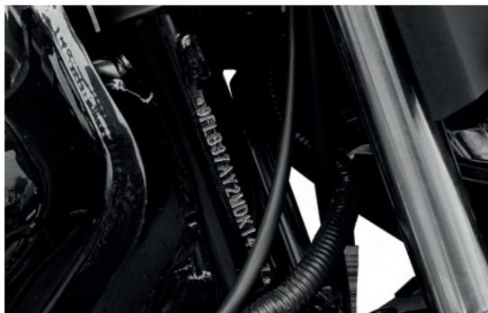
El número de VIN se ubica en la parte frontal derecha del chasis, justo en frente del tanque de combustible
